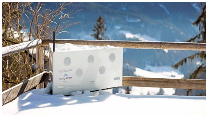
Die Schneewaage – hier in einem weiteren Einsatz in den Tiroler Bergen – eignet sich allgemein für den Einsatz auf Dächern mit einer Neigung von bis zu zehn Grad.
